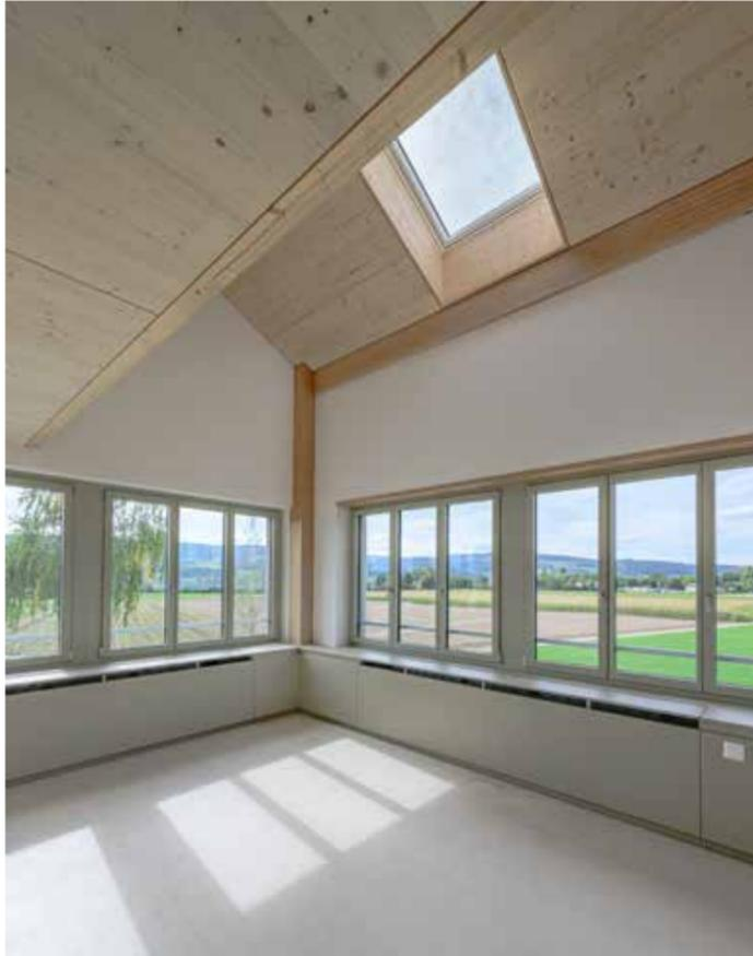
In den Büros sind die Heizkörper für Wärme- und Kälteabgabe sowie der Kabelkanal in die Brüstungselemente integriert.
